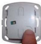
1. Снимите монтажную пластину с корпуса модуля.
