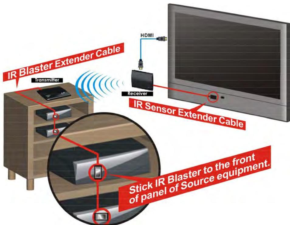
ИК расширитель передает команды пульта ДУ на А/В устройство. При этом Вы можете направлять пульт не на само устройство, а на приемник DVLHD22.
