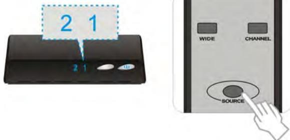
(7) Если рядом с передатчиком или приемником установлен радиотелефон или беспроводная точка доступа, работающие на частоте 5 ГГц, их сигнал может повлиять на качество передаваемого видео- или аудиосигнала. Нажмите на кнопку CHANNEL пульта ДУ для того, чтобы перенастроить канал.
