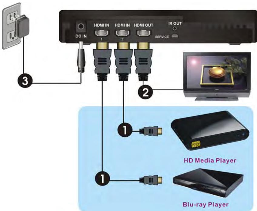
(1) Подключите HDMI кабель (входит в комплект) ко входу "HDMI IN" передатчика и к выходу "HDMI OUT" A/B источника. Передатчик оснащен двумя HDMI входами для подключения современных HD устройств (PS3, Blu-ray плеер и др).
