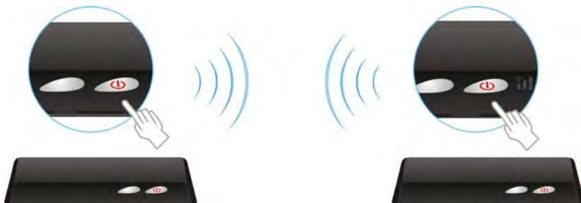
(4) Если индикатор питания на передатчике горит пурпурным цветом (режим Loop through активен), а на приемнике - красным, необходимо нажать на кнопку питания только приемника, тогда и передатчик, и приемник включатся.
