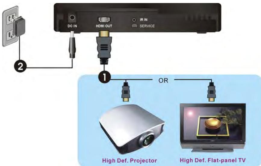
(1) Подключите HDMI кабель к выходу HDMI OUT приемника и к HDMI входу HD-телевизора (или HD проектора). С помощью пульта ДУ Вашего телевизора выберите необходимый "HDMI" вход.
