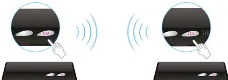
(5) В течение некоторого времени индикатор питания будет мигать синим цветом, пока не установится стабильный сигнал между передатчиком и приемником.
